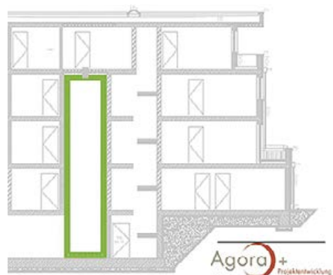
Schnitt eines Sonnenhauses mit 31 m 3 Wasserspeicher
