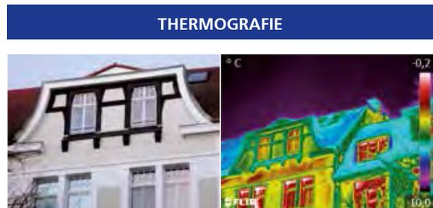
Abb. 9-2 Saniertes Gebäude
