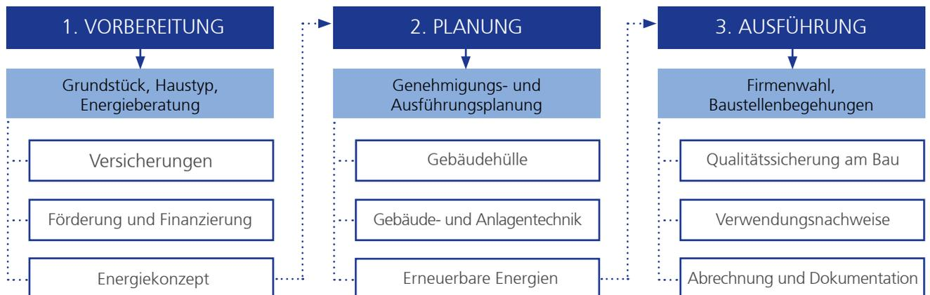
Abb. 1-4 Ablaufplan eines Neubau- oder Sanierungsvorhabens
